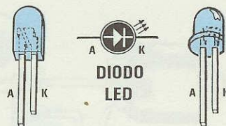
Fig. 2 Qualsiasi tipo di diodo led vorrete utilizzare, piatto, normale o miniatura, ricordatevi sempre che il terminale più lungo è l'Anodo ed il più corto il Catodo. Le connessioni dei due transistor BC328 e del Darlington BC517 sono identiche.
